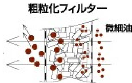
《粗粒化フィルター のシステム》
